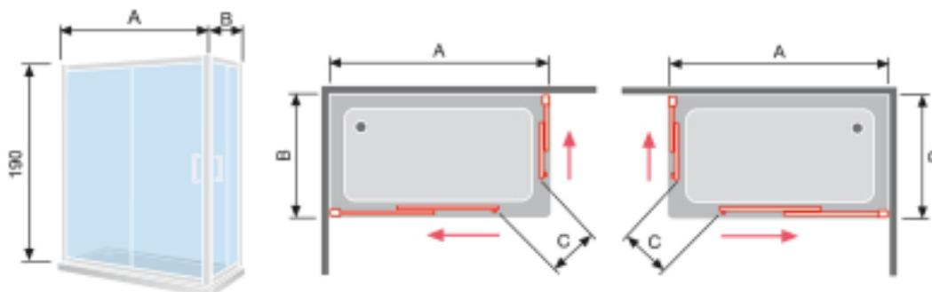
Mampara para plato de 1,80 de ancho y 1,95m. de altura, frente completo, compuesta por 2 fijos laterales y dos puertas correderas. Vidrio templado de 6 mm. y perfil de aluminio anodizado plata alto brillo.
