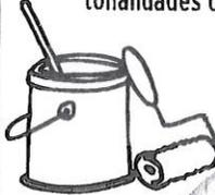
**Pintura en paredes:** es preciso esperar a que esté seca, observando si hay fisuras o grietas, así como que la pintura es homogénea y no hay variación de tonalidades o colores.
